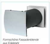
EcoVent Verso gehört zur Kategorie der Umschalt-Lüftungsgeräte mit Wärmerückgewinnung. Es ist für die Montage in der Gebäudeaußenwand vorgesehen. Der Luftdurchtritt erfolgt auf der Wandaußenseite über eine Blende aus Edelstahl. Auf der Wandinnenseite dient hierzu eine verschließbare Kunststoffblende, in der ein Faservlies-Luftfilter der Klasse G3 und eine Schalldämmung integriert
