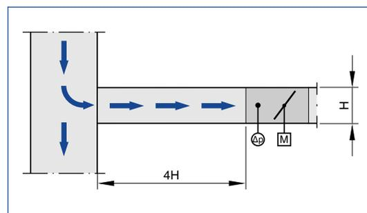
Das Abzweigen einer Strömung von einer Hauptleitung verursacht starke Turbulenzen. Die angegebene Volumenstromgenauigkeit ΔV̇ ist nur mit mindestens 4H gerader Anströmlänge zu erreichen. Kürzere Anströmlängen sind mit einem Lochblech in der Abzweigleitung vor dem VVS-Regelgerät möglich. Direkter Anschluss, auch mit Lochblech, kann zu instabiler Regelung führen.
