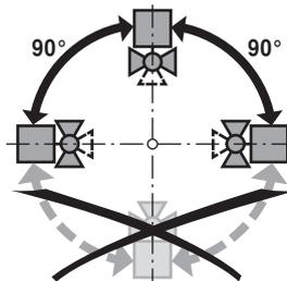
**Einbau im Rücklauf** Der Einbau im Rücklauf wird empfohlen.
