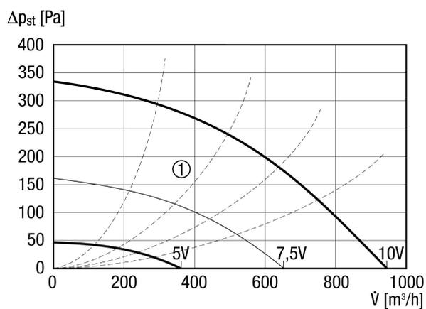
① Hilfskennlinien zu Steuerspannung 5 - 10 V
