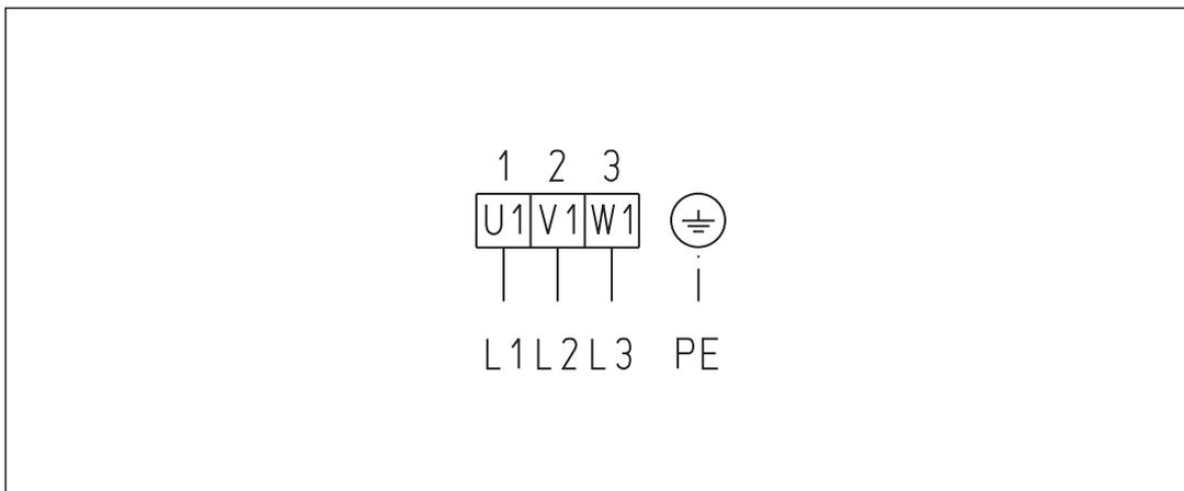
Drehstrommotor ohne TK
